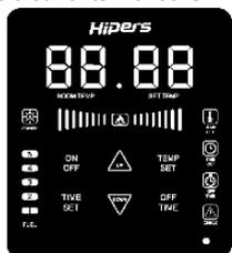
4. Pendant le fonctionnement, "température ambiante" et "température réglée" sont affichées, et si vous appuyez sur la touche ON/OFF et arrêtez le fonctionnement, seule la "température ambiante" est affichée.
