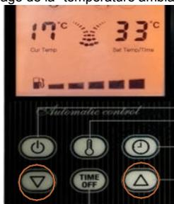
4. Pendant le fonctionnement, "température ambiante" et "température de réglage" sont affichées, et si vous appuyez sur la touche ON/OFF et arrêtez le fonctionnement, seule la "température ambiante" est affichée.
