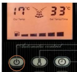
2. Sélectionnez le mode de contrôle de la température en appuyant sur la touche "Set Temp".
