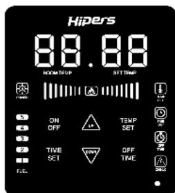
2. Sélectionnez le mode de régulation de la température en appuyant sur le bouton "Set Temp". Le voyant de température s'allume alors.
