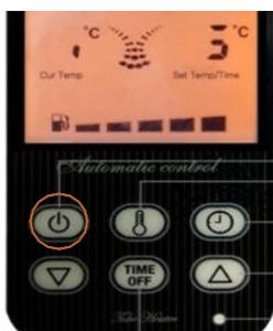
2. Sélectionnez le mode de contrôle de l'heure en appuyant sur la touche "Set Time". - L'indicateur de contrôle du temps est alors allumé.
